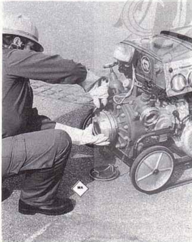
Abb. 15: Ankuppeln eines Übergangsstückes A/B am Saugeingang der TS durch den MA
