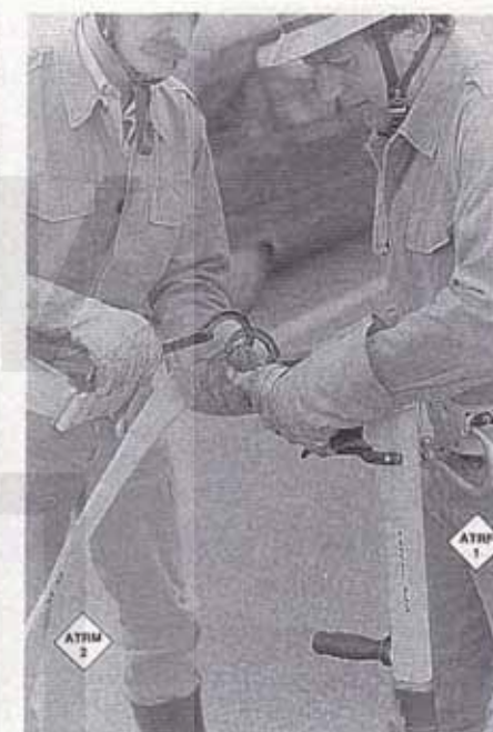
Abb. 41: Ankuppeln der faltbaren Hochdruckschläuche an das Hochdruckstrahlrohr mittels H-Kupplungsschlüssel
