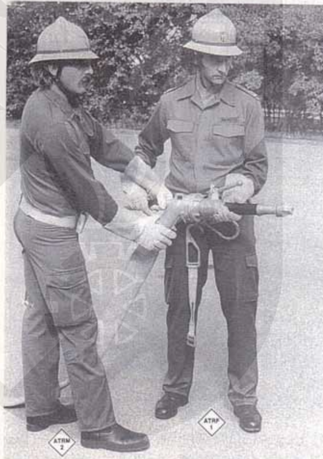
Abb. 29: Vornahme eines B-Strahlrohres unter Verwendung eines Stützkrümmers durch den ATR (1,2)
